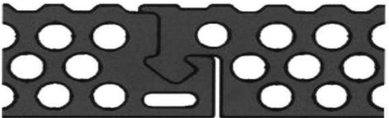
Рисунок 3.10 – Замковая система соединения матов S 22-04 фирмы Datwyler
