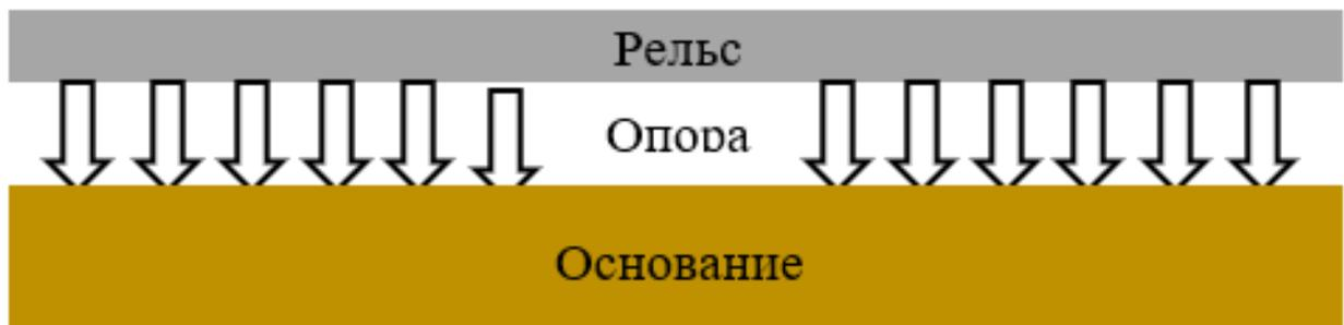
Рисунок 2.1 – Однослойная модель рельсового пути (непрерывное опирание)
